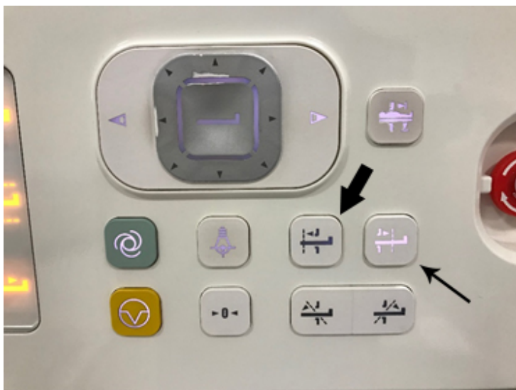
Рис. 13. Консоль управления на гентри компьютерного томографа. Кнопка перемещения из гентри до внешнего маркёра (тонкая стрелка). Кнопка перемещения в гентри до внутреннего маркера (толстая стрелка) [оригинальный рисунок].
