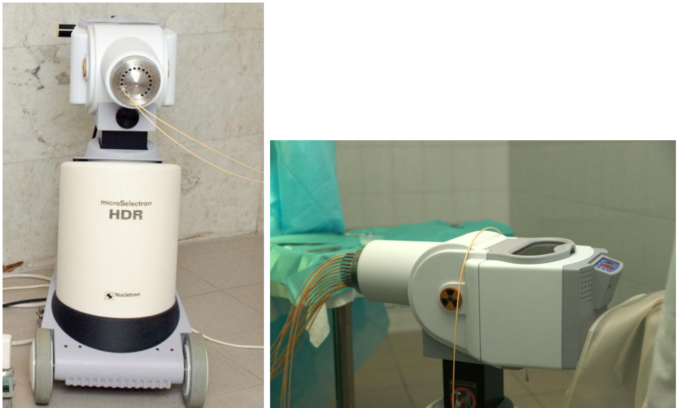
Рисунок 14 – Аппарат MicroSelectron для брахитерапии фирмы «Nucletron»
