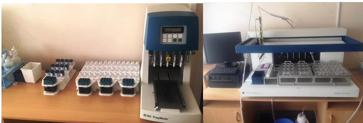
Рис. 6. а) процессор PrepMate для автоматического переноса клеточного материала из виалы в пробирку; б) процессор PrepStain для автоматического приготовления и окрашивания цитологических препаратов
