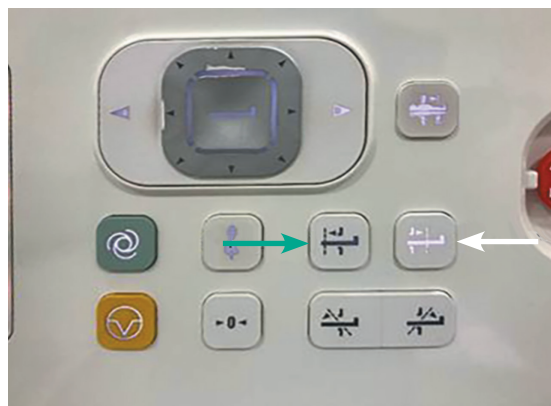
Рис. 56. Консоль управления на гентри компьютерного томографа. Кнопка перемещения из гентри до внешнего маркера (белая стрелка). Кнопка перемещения в гентри до внутреннего маркера (зеленая стрелка)
