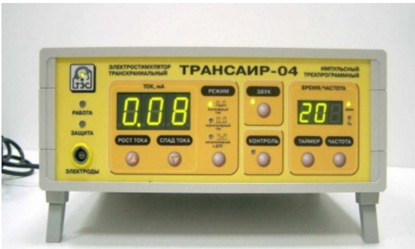
Рис. 1. Аппарат для ТЭС-терапии «Трансаир-04». Общий вид (оригинальный рисунок).
